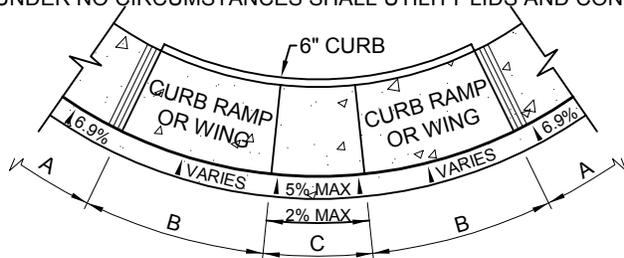
**TYPICAL GUTTER TRANSITION AT CURB RAMP**
