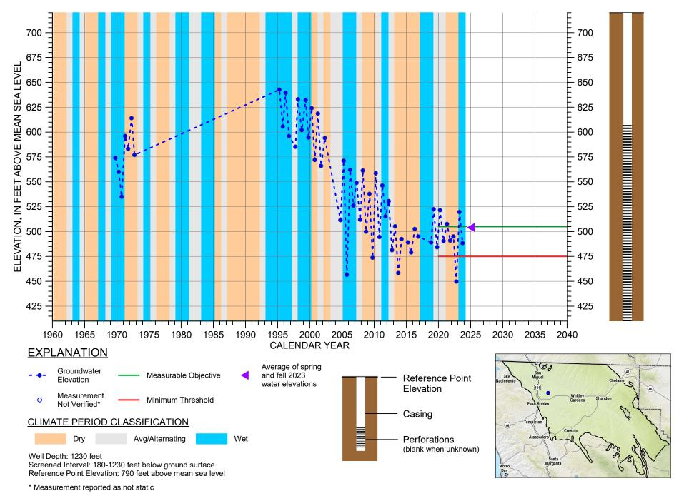
HYDROGRAPH OF MEASURED GROUNDWATER ELEVATION FOR 26S/12E-14H01
