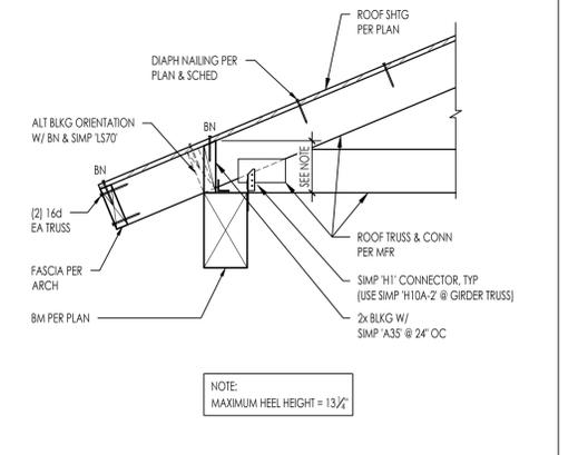
ROOF TRUSS PERP TO BEAM
