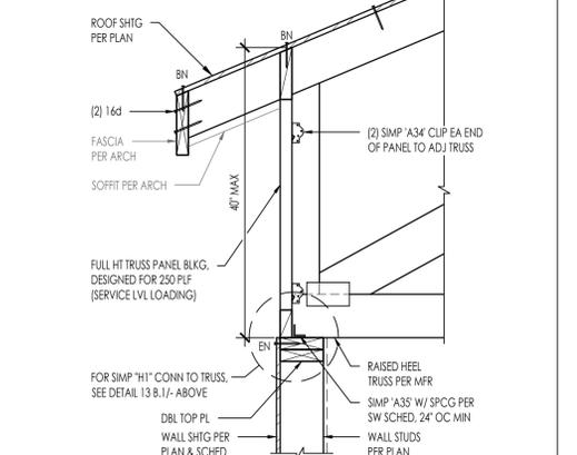
ROOF TRUSS PERP TO EXTERIOR WALL
