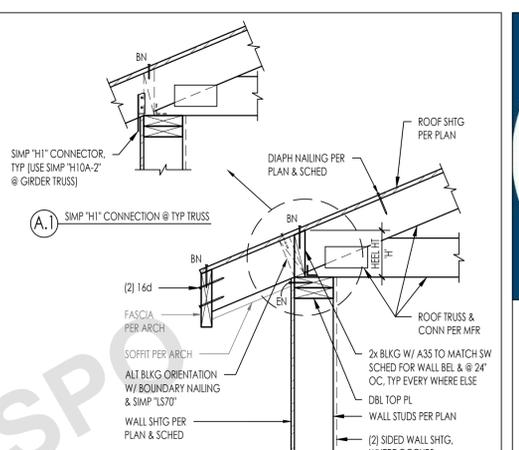
ROOF TRUSS PERP TO EXTERIOR WALL
