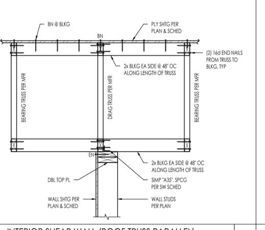
INTERIOR SHEAR WALL (ROOF TRUSS PARALLEL)
