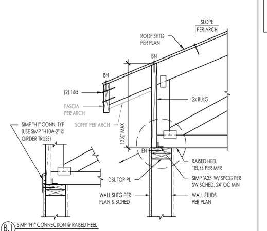
ROOF TRUSS PERP TO EXTERIOR WALL
