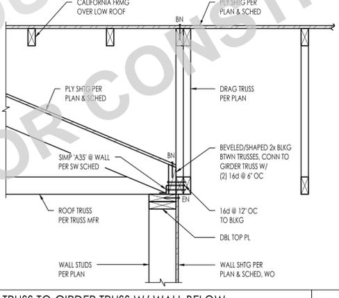
TRUSS TO GIRDER TRUSS W/ WALL BELOW
