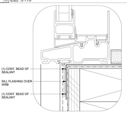
**13 DETAILED SILL FLASHING**
