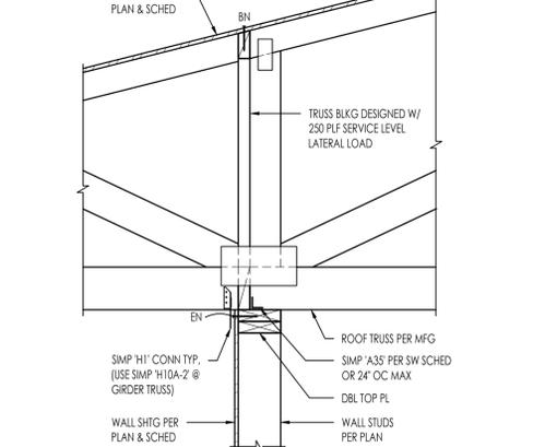
TRUSS INTERIOR BEARING WALL
