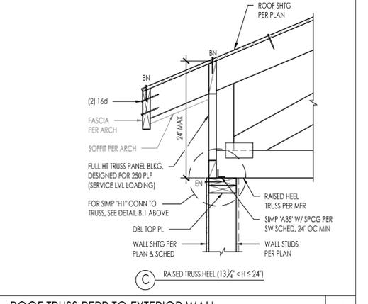
ROOF TRUSS PERP TO EXTERIOR WALL
