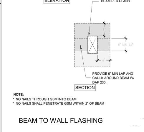
**52 BEAM TO WALL FLASHING**
